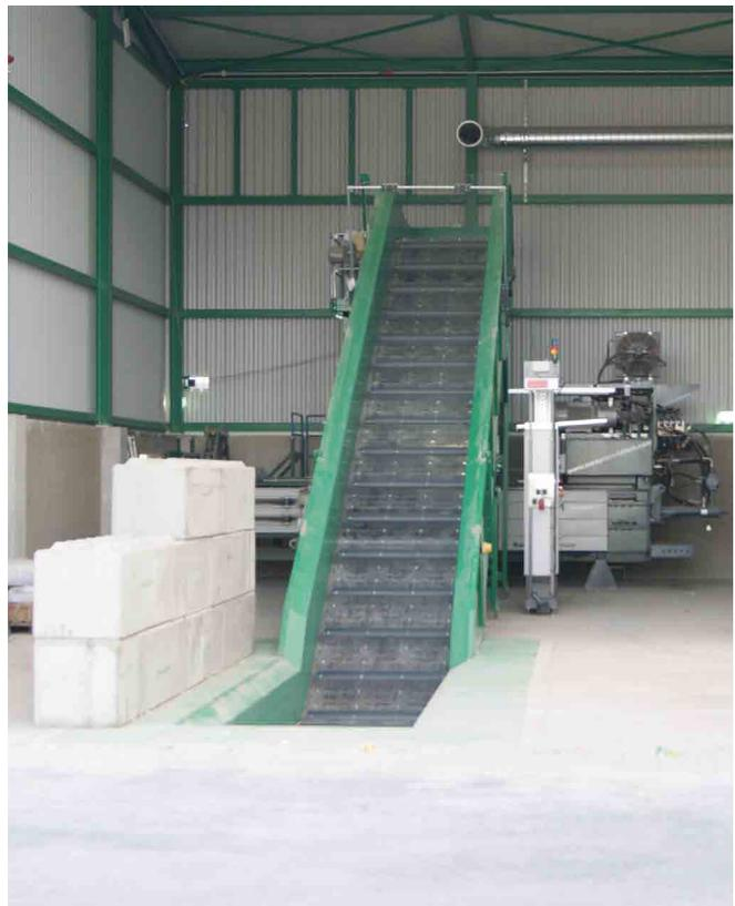
Die Fördertechnik kann mit zusätzlicher Erhöhung der Seitenwände zu einem Materialspeicher ausgebaut werden. Um das Band zu befüllen, benötigt man ein Hebegerät mit Schaufel oder Greifer. Im Gegensatz zu der Unterflur-Variante, ist diese Bauart auch als mobile Lösung erhältlich.
