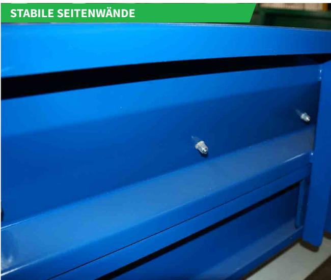
Stabile Seitenwände sind Standard, in einer Profilrahmenkonstruktion zur einfachen Montage und Demontage am C-Profil Rahmen. Seitenwände aus einem 3mm starken Rahmen mit 5mm starken Profilen zur Befestigung am C-Profil.
