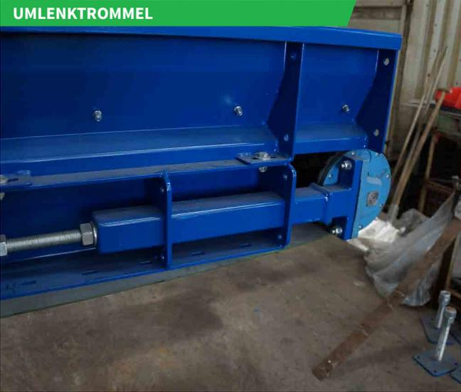
Sowohl die Antriebs- als auch die Umlenktrummeln sind mit Spannhülsen und durchgehenden Wellen versehen, dadurch sind die Welle und die Trommeln separat austauschbar.
